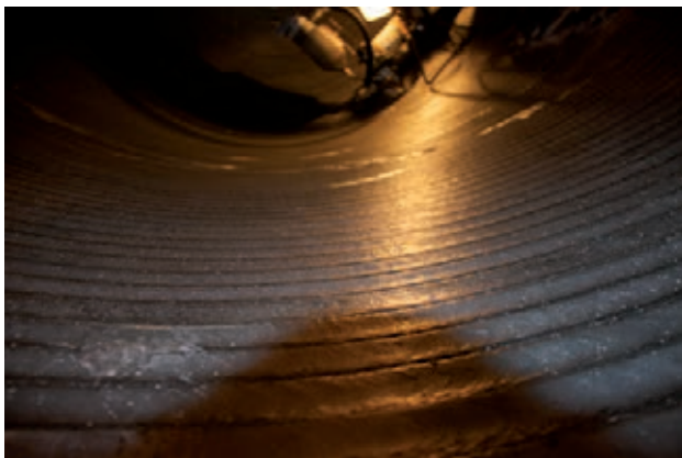
Bandplattierung: BF 44 / BA-Strip 309LNb / Abmessung 60×0,5 mm
