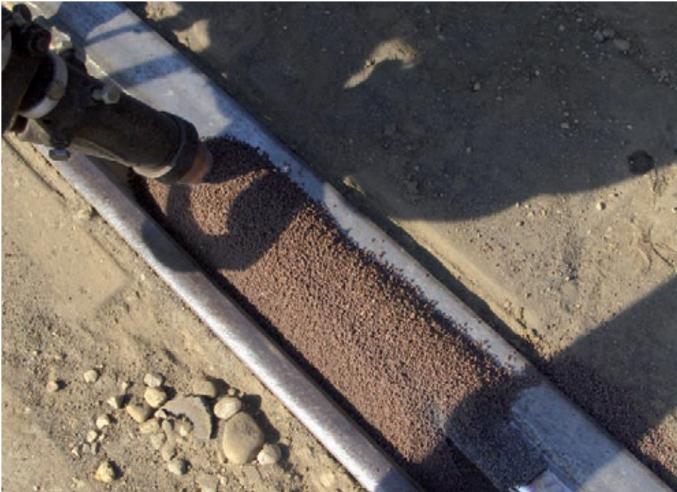
BF 4 mit Fülldraht Ø 4,00 mm Typ 18.8.6 L
