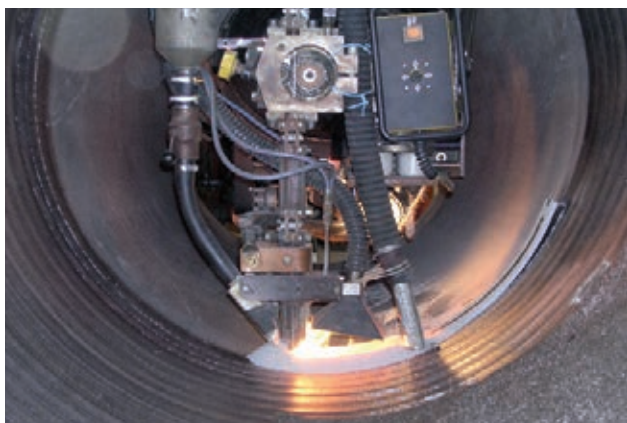
Bandplattierung: BF 44 / BA-Strip 309LNb / Abmessung 60×0,5 mm
