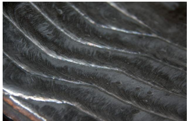
**Bandplattierung:** BF 44/BA-Strip 309LNb / Abmessung 60×0,5 mm
